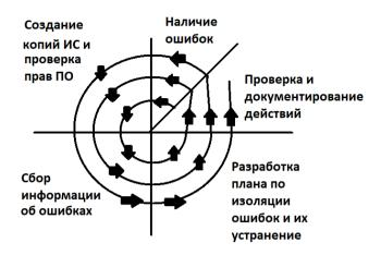
Рис. 2. Спиральная модель «Базовая модель поиска ошибок системного администратора»
