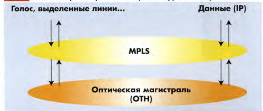
Рис. 3 Пакетно-ориентированная архитектура магистральной сети
