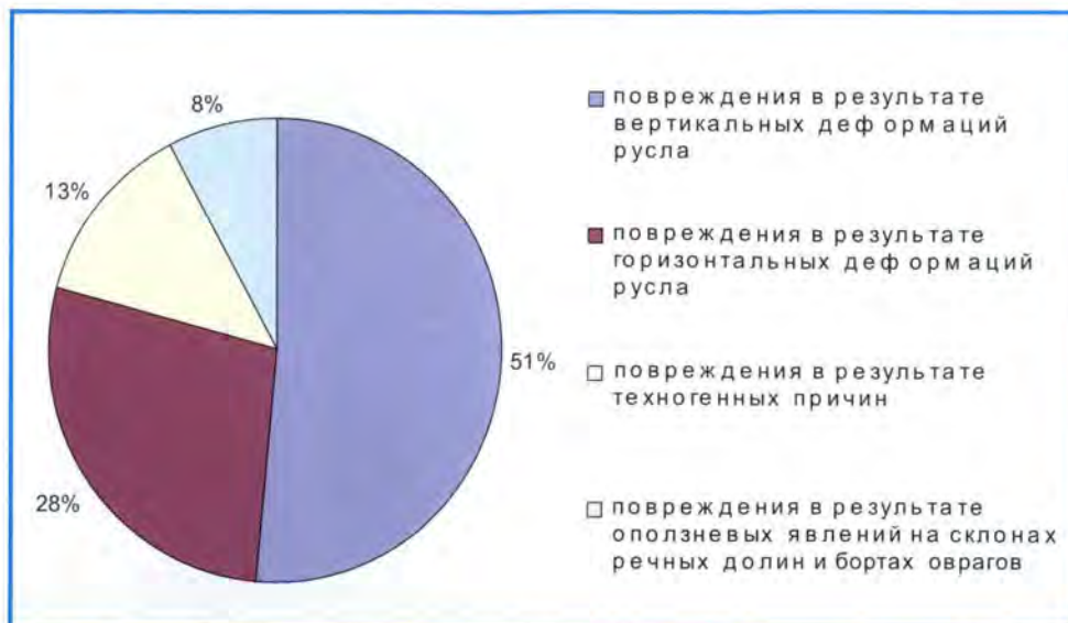
Рис. 1. Распределение причин аварийных ситуаций на подводных кабельных переходах (по данным ОАО «Ростелеком»)
