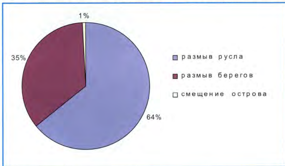
Рис. 2. Виды русловых деформаций как причины аварийных ситуаций на кабельных переходах
