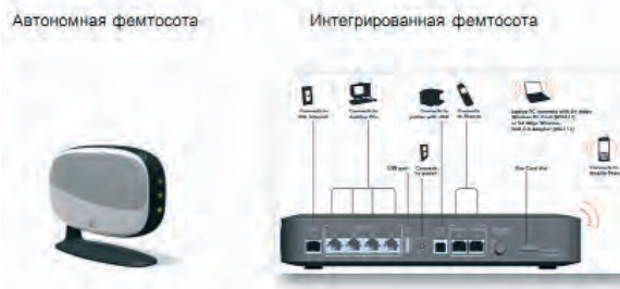
Рис. 2 Автономная и интегрированная фемтосоты
