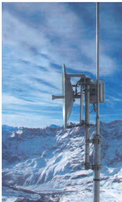
Система PTP 500 фирмы Motorola работает на линиях, длина которых достигает 250 км
