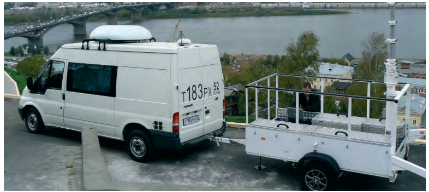
Передвижной комплекс радиоконтроля на базе автоприцепа для легкового автомобиля
