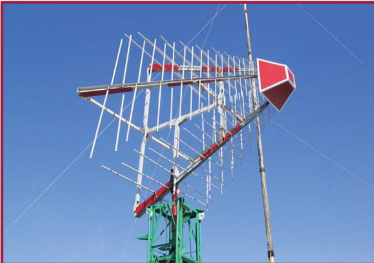
Логопериодическая антенна с двумя ортогональными поляризациями, разработанная по заданию ФГУП «РЧЦ СФО» в Омском ГТУ
