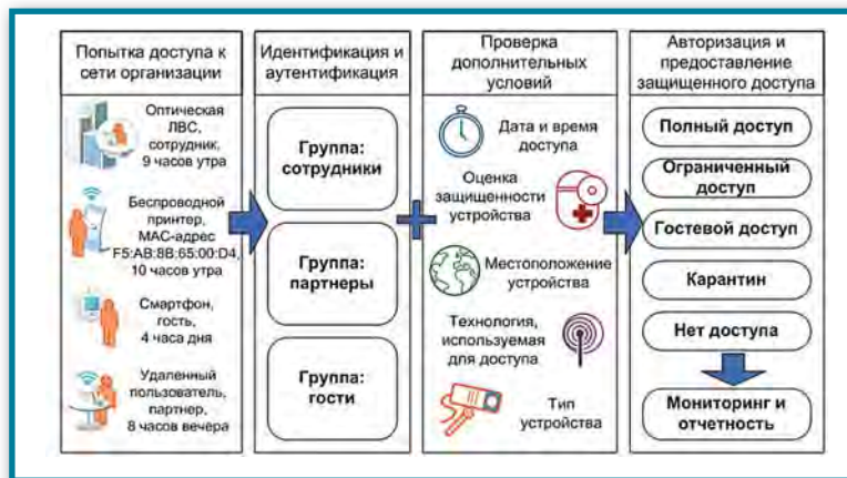
Рис. 2. Принцип работы Cisco TrustSec
