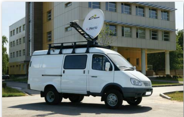
Передвижной комплекс VSAT на базе автомобиля «Газель»
