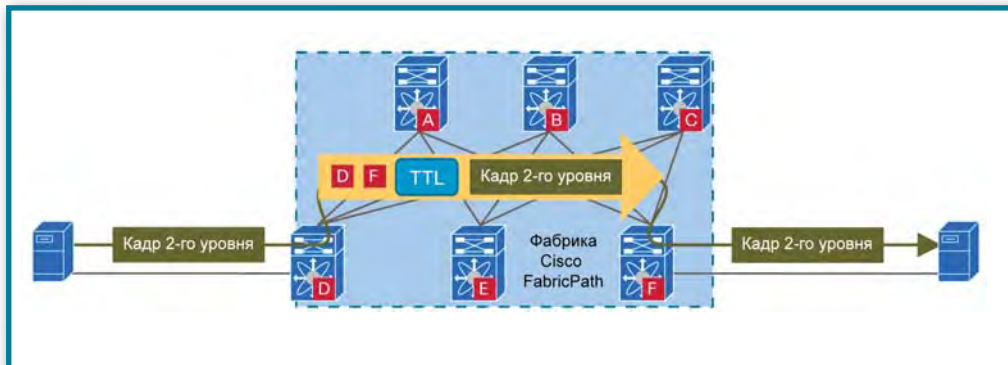
Рис. 1. Пересылка кадра через фабрику FabricPath
