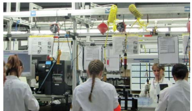
На линии производства цифровых телевизионных приставок Cisco в Твери каждая девушка делает свою операцию в среднем за 23 секунды
