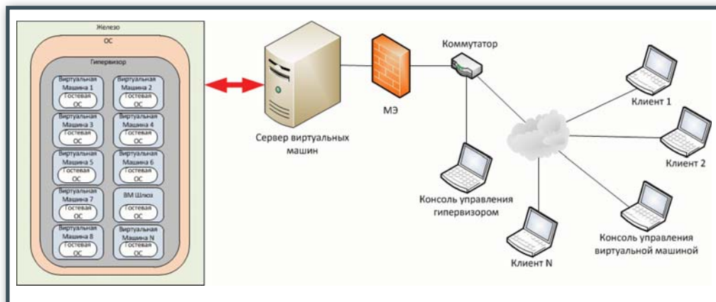
Рис. 2. Структурная схема работы гипервизора уровня базовой ОС
