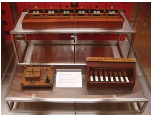
Электромагнитный 6-мультипликаторный телеграфный аппарат П.Л. Шиллинга. Мастерская механика И.А. Швейкина, Санкт-Петербург, 1832. ЦМС им. А.С. Попова
