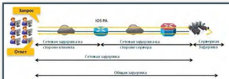
Рис. 1. Мониторинг времени отклика TCP-приложений в маршрутизаторах Cisco ISR G2
