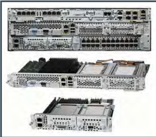
Рис. 2. Серверные платформы Cisco UCS E для маршрутизаторов Cisco ISR G2 серий 2900 и 3900
