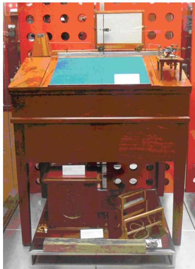
Пишущий электромагнитный телеграфный аппарат Б.С. Якоби в конторке из красного дерева. Копия аппарата, работавшего в Главном штабе с 1842 г. ЦМС им. А.С. Попова
