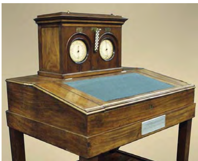
Стрелочный двухциферблатный телеграфный аппарат Б.С. Якоби, 1840. Применялся на линии связи между кабинетом Николая I в Зимнем дворце и кабинетом главного управляющего путями сообщений на Фонтанке
