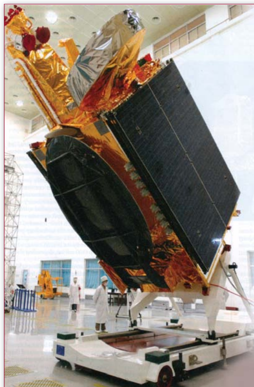
Китай дорабатывает свою телекоммуникационную спутниковую платформу DFH-4, снабдив ее полностью электрическими двигателями маневрирования
