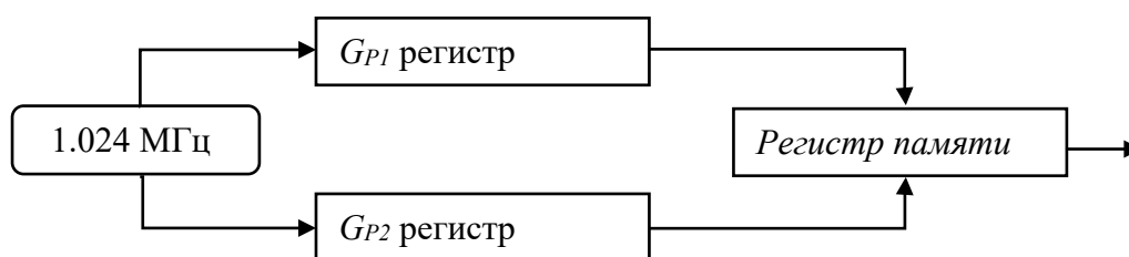
Рис. 5. Схема параллельного генератора C/A кода с использованием регистра памяти
