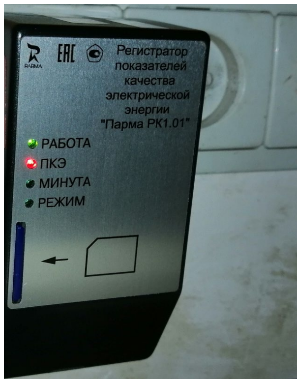
Рис. 2. Установка регистратора показателей качества электроэнергии Парма РК 1.01
