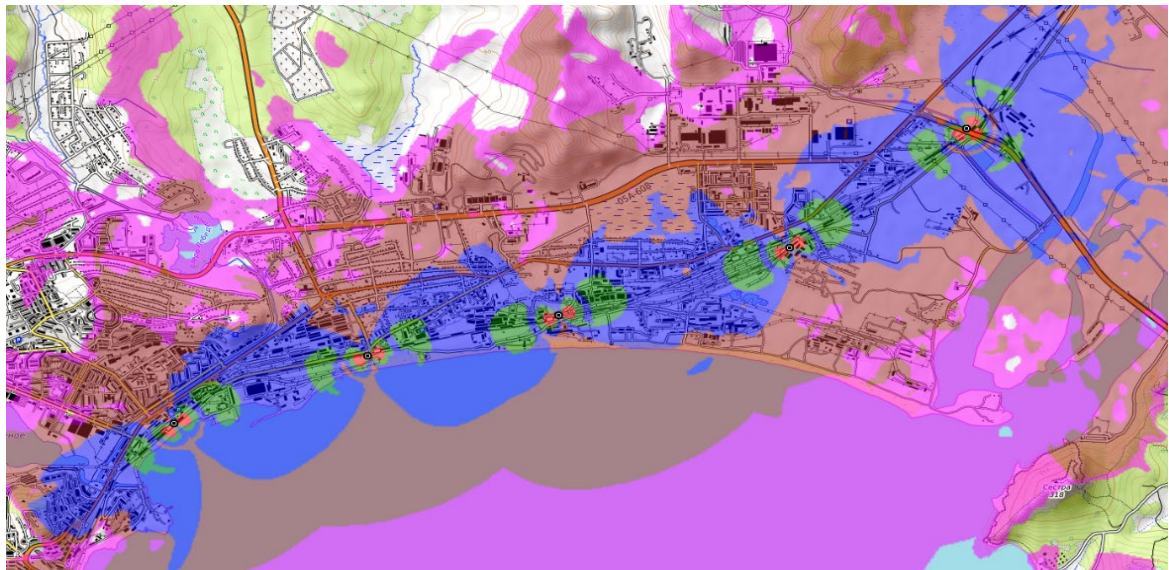
Рис. 1. Карта распределения доступных видов модуляции на линии «вниз» при учете внутрисистемных помех (зеленый цвет – 16 QAM, синий цвет – QPSK)
