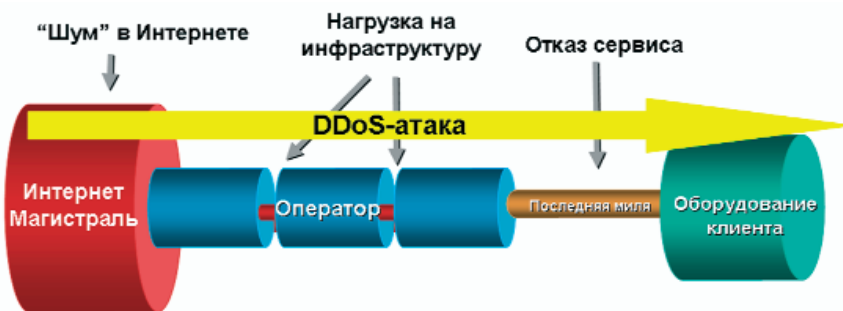
Рис. 2 Влияние DDoS-атаки на различные элементы сети Интернет
