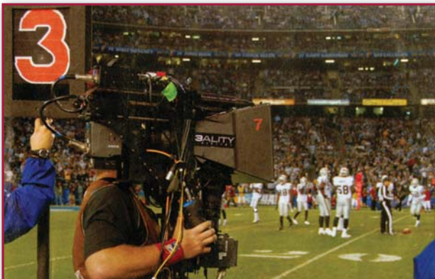
Рис. 2. 3D-зеркальные (отражательные) оснастки также могут использоваться для переносных съемочных камер. Такая оснастка фирмы Zality Digital несет на себе две камеры Sony, ПЗС, телевизионные головки которых размещены на необходимом расстоянии друг от друга с помощью адаптеров Sony НКС-T1500
