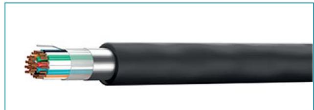
Конструкция телефонного кабеля с полиэтиленовой изоляцией в пластмассовой оболочке с гидрофобным наполнением марки ТППЭпЗ
