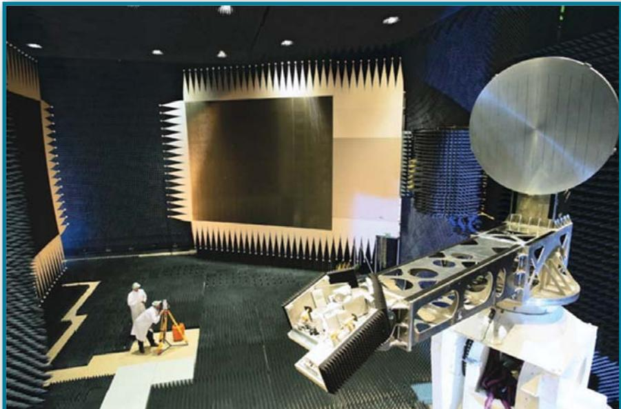
Рис. 5. Двухзеркальный компактный полигон в безэховой камере
