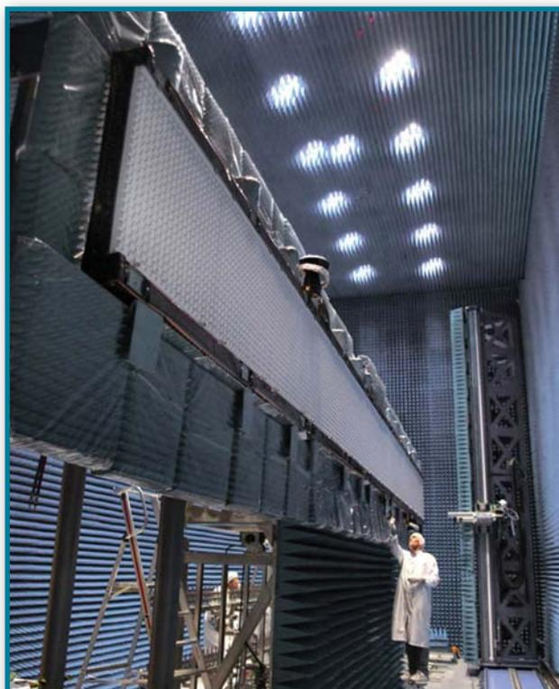
**Рис. 8. Подготовка к измерению характеристик крупногабаритной АФАР на стенде ближнего поля**
