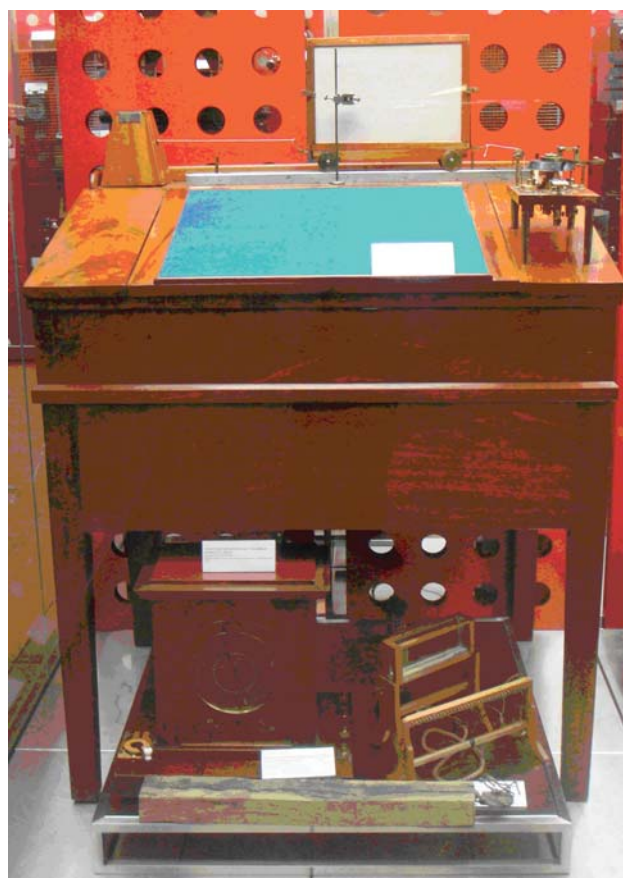
Пишущий электромагнитный телеграфный аппарат Б.С. Якоби в конторке из красного дерева. Копия аппарата, работавшего в Главном штабе с 1842 г. ЦМС им. А.С. Попова
