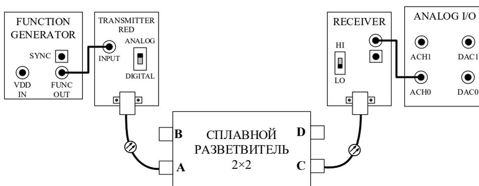
Рис. 3. Схема измерения вносимых оптических потерь сплавным разветвителем
